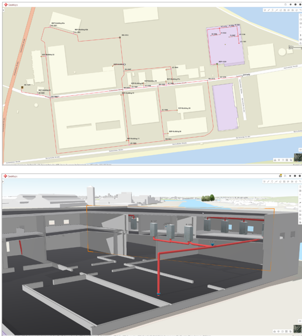
Eine GIS-Applikation macht Assets und Ressourcen in Kabelnetzen transparent: Infrastrukturobjekte werden nicht nur georeferenziert auf Karten angezeigt, sondern bis auf Ebene von Stockwerken und Räumen.
